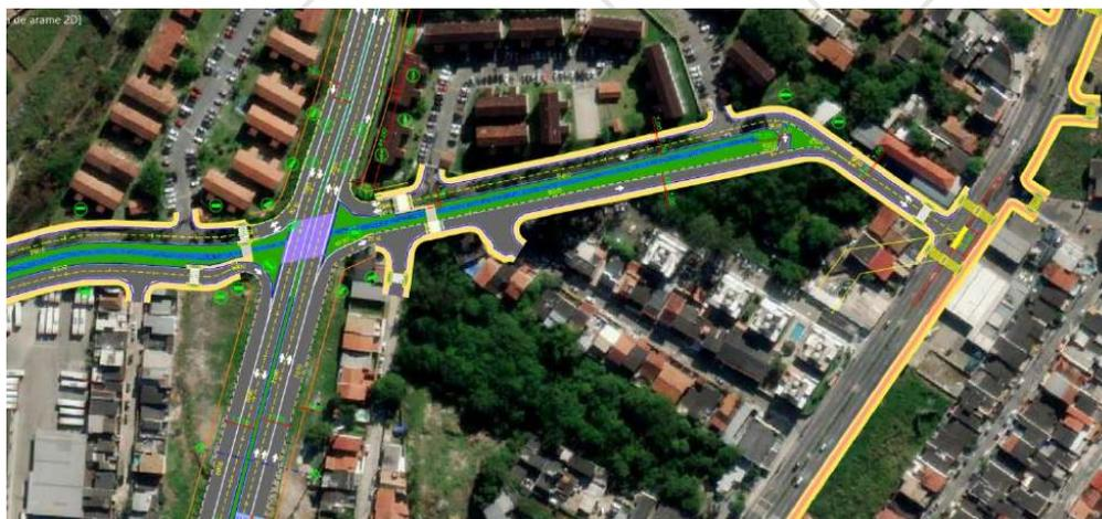
**Figura 11: Configuração geométrica proposta na Av. Mergulhão.**
