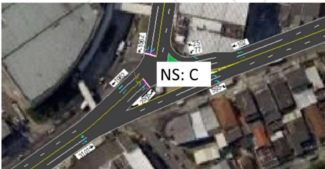
Figura 78: Nível de Serviço para a Interseção da Estrada da Posse x Estrada do Mendanha
