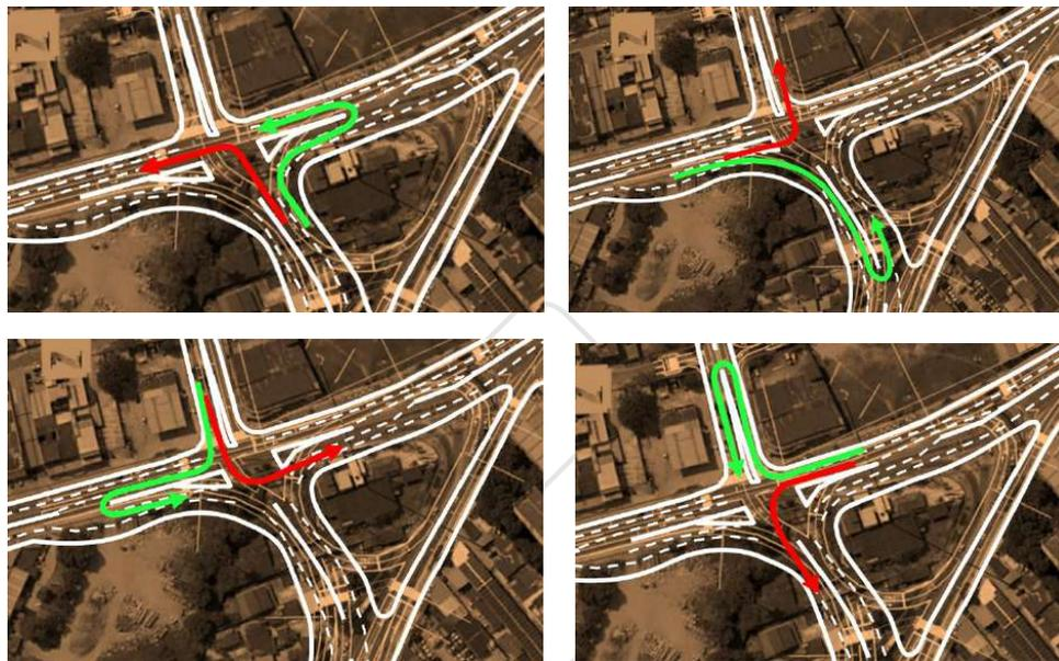
Figura 89: Rotas propostas para realizar o giro à esquerda
