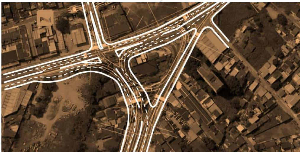
Figura 88; Configuração proposta para reduzir o tempo semaforico
